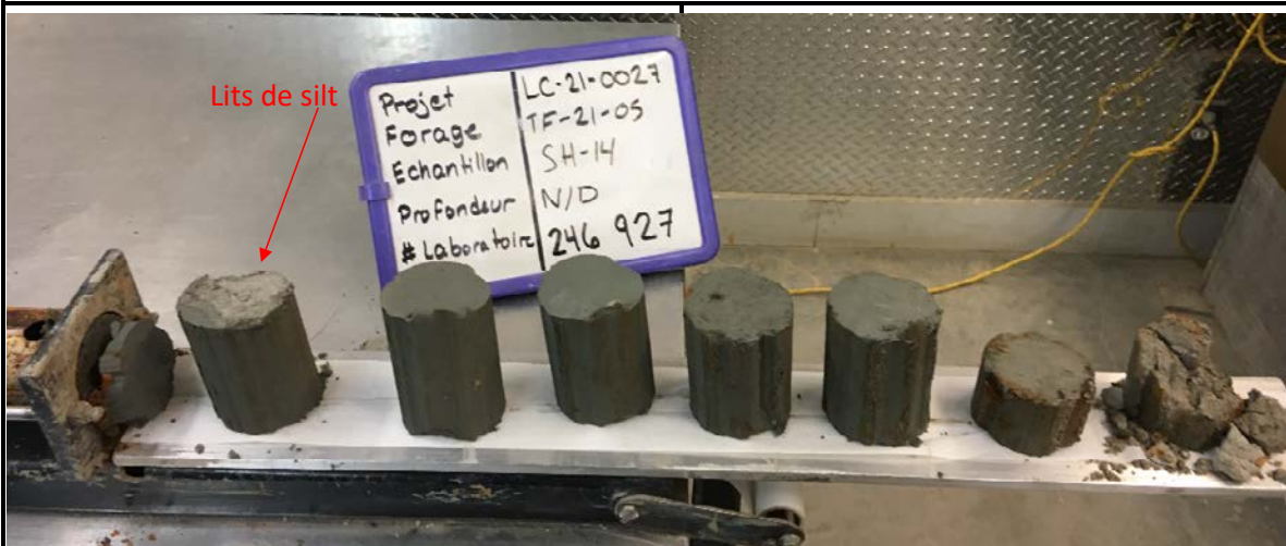
Photographie n° 3 : Sous sections, structure homogène, lit de silt à 0,49 - 0,59 m* Échantillon # 246 927 / TF-21-05 SH-14
