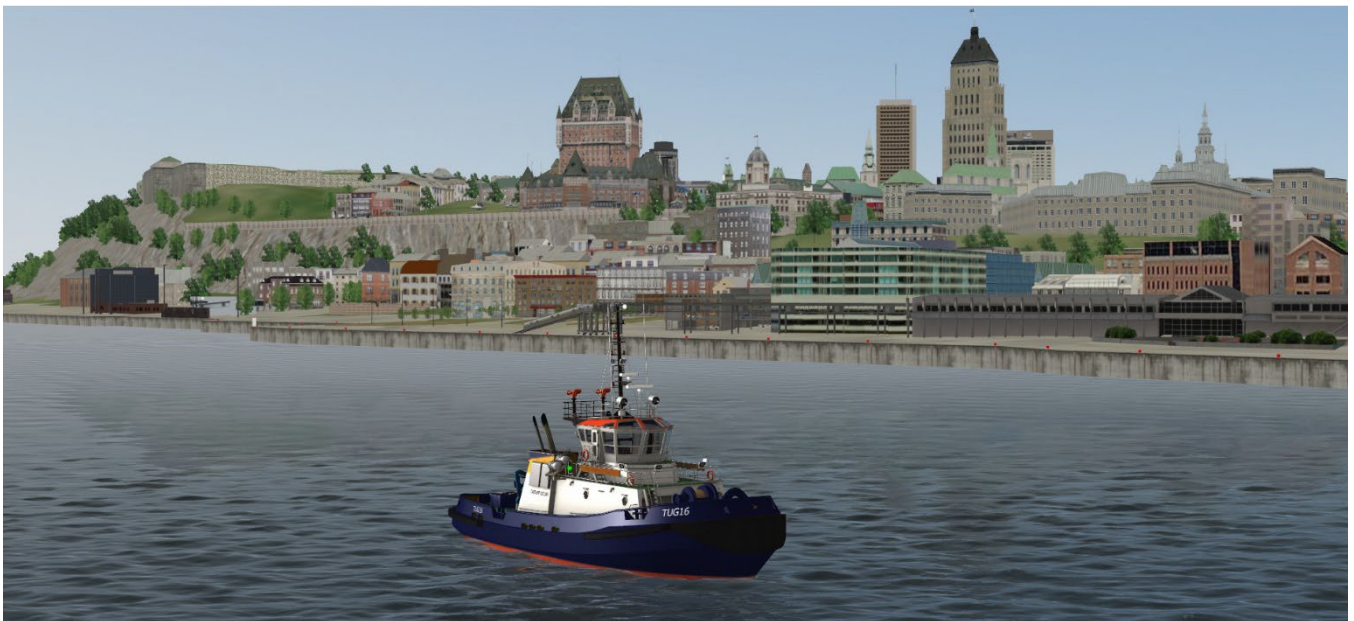
Illustration 12: Le remorqueur TUG 16, muni de 2 hélices orientables en azimuth (Type ASD – Azimuth Stern Drive).
