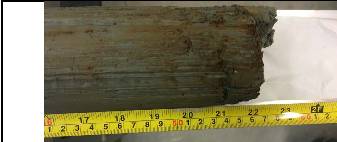
Photographie n° 2 : Extrémité du haut , présence d'oxydation Échantillon # 245 924 / TF-21-04 SH-12
