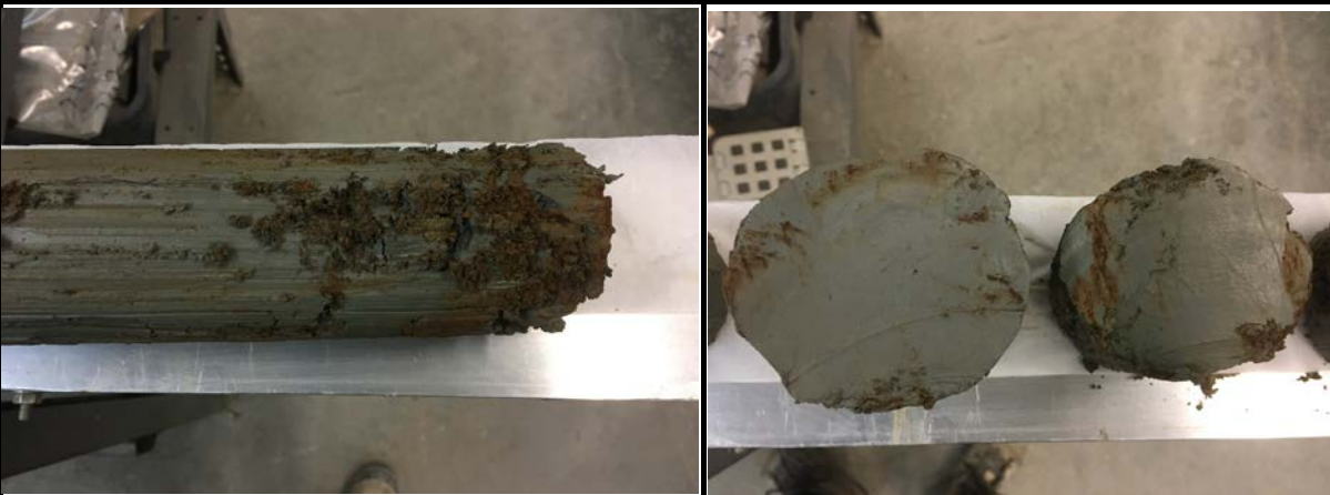
Photographie n° 2 & 3 : Présence d'oxydation Échantillon # 246 924 / TF-21-05 SH-19
