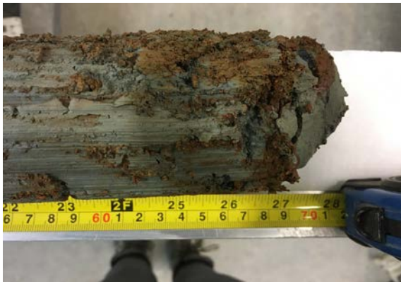
Photographie n° 2 : Extrémité du haut , présence d'oxydation Échantillon # 246 928 / TF-21-05 SH-17
