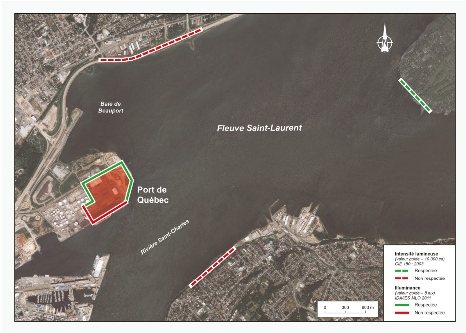
Figure 7.13 Simulation de l'intensité lumineuse projetée par les installations actuelles du Port de Québec
